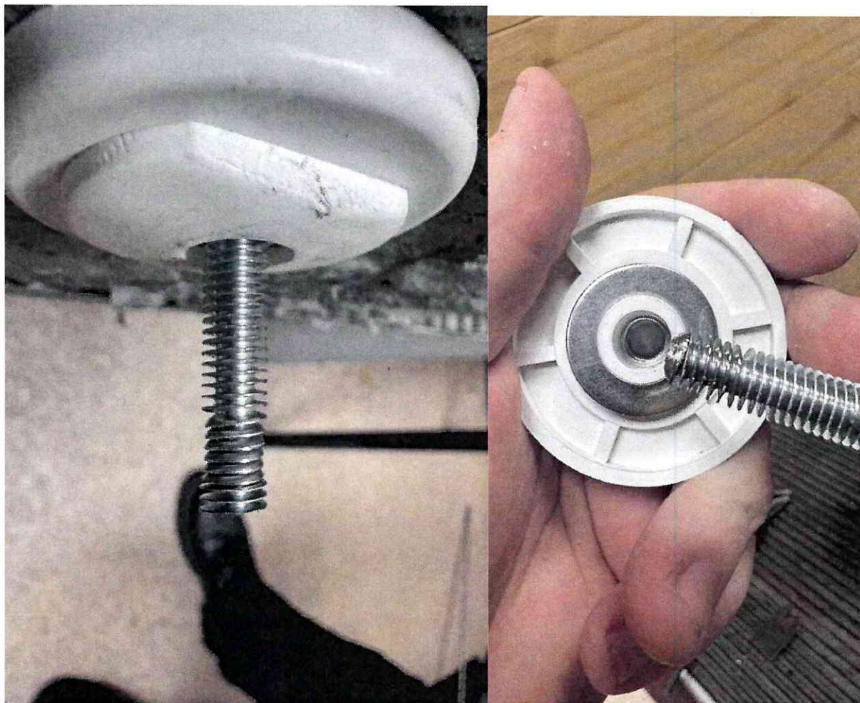
Фото 4 – Деформация витков резьбы
